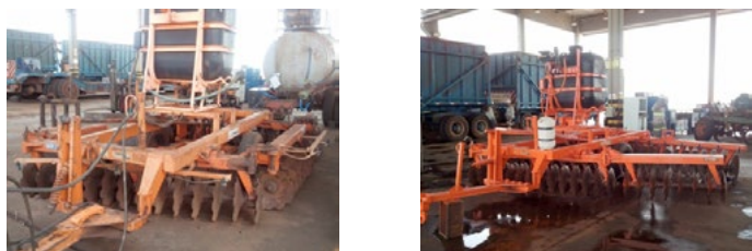
Figura 2 e 3: Implementos para aplicação de Trifluralina Gold incorporada (de 1,2 a 2,4 litros/ha).
