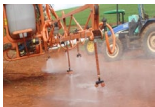
Figura 12: Autopropelido com pingente para aplicação de herbicida pós quebra-lombo
