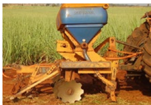
Figura 11: Implemento de quebra-lombo com herbicida conjugado
